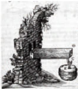
Fig. 6. Resistenza di una trave allo sforzo longitudinale.
