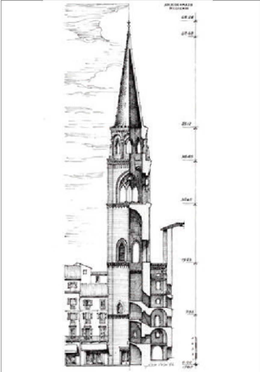
Fig. 4. Prospetto e sezione del campanile visti da piazza Mantegna (disegno di Livio Volpi Ghirardini, 1987).
